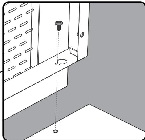
Schrauben einsetzen, aber nicht festziehen, um nachfolgende Schrauben leichter zu positionieren.
