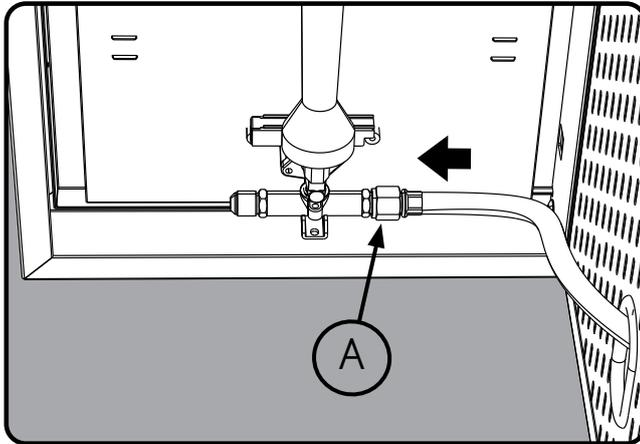
Schließen Sie den Gasschlauch und die Gruppe A mit 2 Schraubenschlüsseln an den seitlichen Brenneranschluss an.
