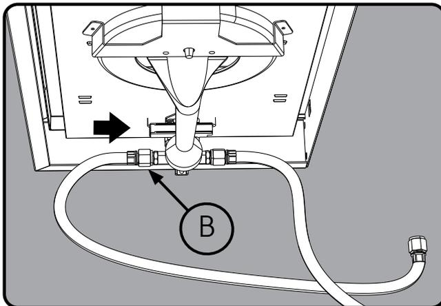
Schließen Sie den Gasschlauch (B) mit 2 Schraubenschlüsseln an den verbleibenden Anschluss am Seitenbrenner an.
