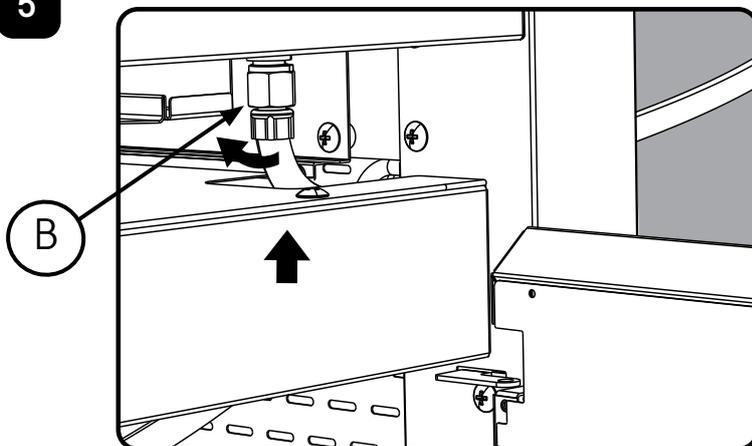
Schließen Sie die andere Seite des Gasschlauchs (B) mit 2 Schraubenschlüsseln an den Anschluss des Grills an.
